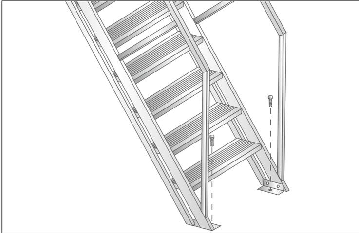
**NL** » Plug de onderste bevestigingsbeugels op dezelfde manier vast in de grond. Gebruik uitsluitend geschikte veiligheidsankers/pluggen. Controleer na de opbouw van de trap alle maten en alle bevestigingen en draai deze eventueel aan.
